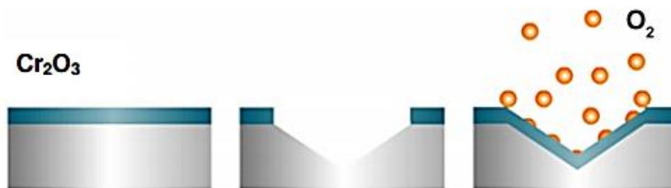
Slika 3. Samoobnavljanje pasivnog filma hromovih oksida na nerđajućem čeliku [21]
