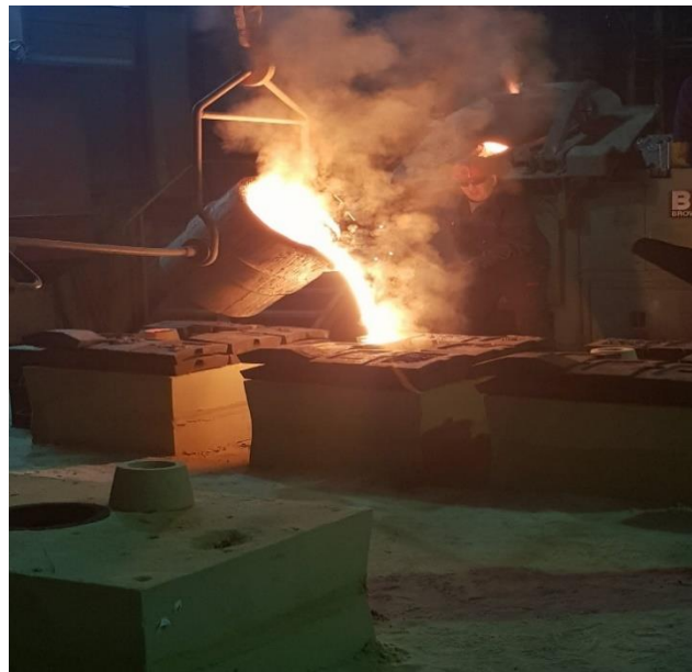
Slika 22. Proces livenja u kalupe, Institut za crnu metalurgiju-Nikšić
