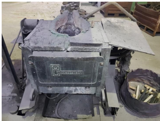
Slika 19. Indukciona peć, ICM-Nikšić
